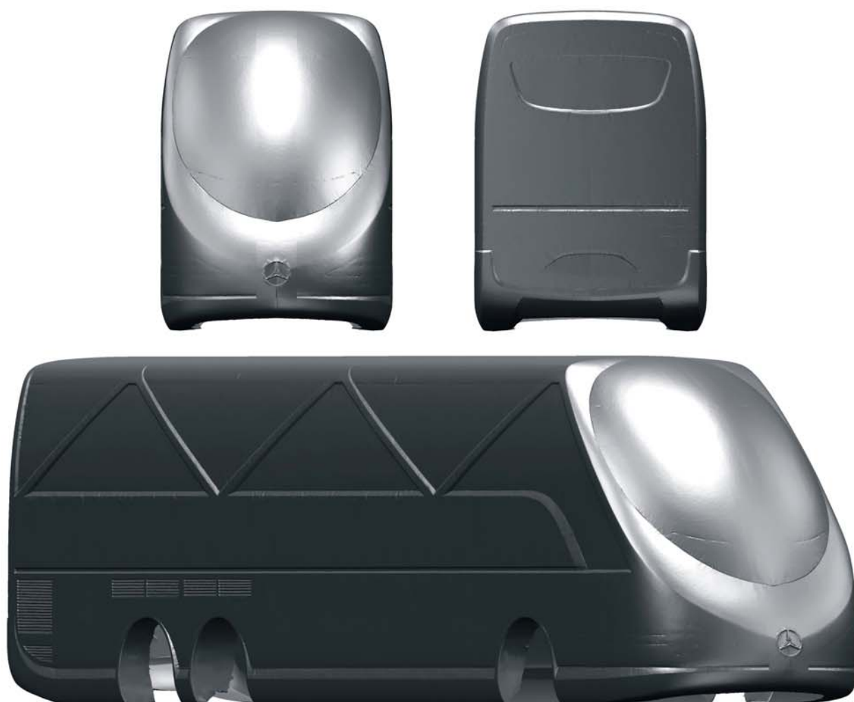
Clay modell alapján 3D-s scannerrel digitalizált adatállomány „részletgazdagtalansággal”.
