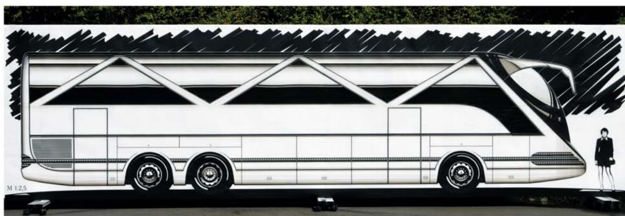
A Securo 15 SHD modellről M 1:2,5 méretű tape-renderinget készítettem. A végleges változat részleteiben eltér az itt látható megoldástól.
