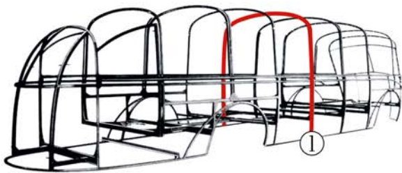
1. a jármű teljes keresztmetszetén végigfutó, tetőt tartó oszlopok
