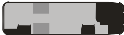
2.066.kép Ikarus 30 városi kisautóbusz utasáramlása és térfelosztása 1959
