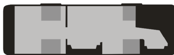
3.015.kép Ikarus 405.06 minibusz utasáramlása és térfelosztása 1994
