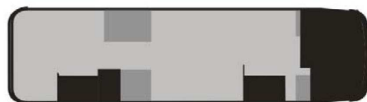
2.067.kép Ikarus 31 városi kisautóbusz utasáramlása és térfelosztása 1959
