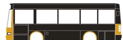
3.014.kép Ikarus 405.06 minibusz sziluettje, takarólécezése, lemezélése és műanyagburkolata
