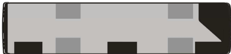
2.092.kép Ikarus 260 városi közepes autóbusz utasáramlása és térfelosztása 1974
