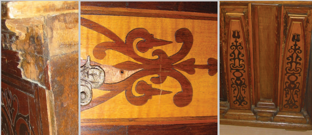
A FURNÉR VASTAGSÁGA A SÉRÜLÉSEK HELYÉN TANULMÁNYOZHATÓ JÓL SÁROSPATAKI AJTÓ RÉSZLETE SZÁRHEGYI LÁDA IMM
