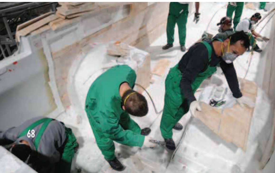
62. ábra, Balsafa réteg terítése
