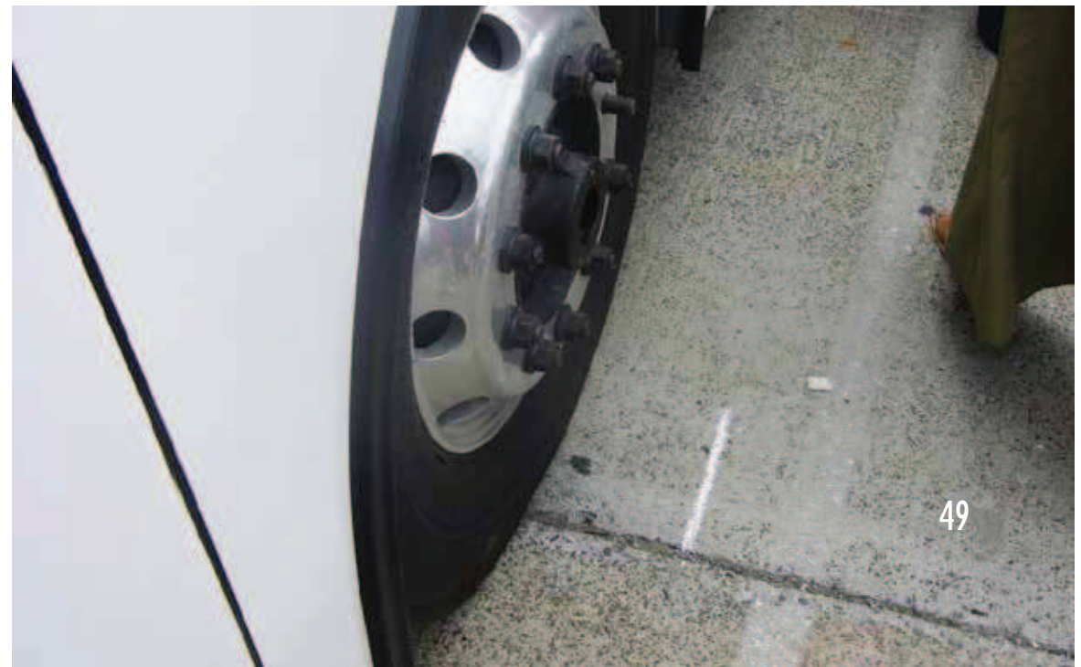
42. ábra, Jármű szekrény oldalirányú elmozdulásának mértéke a becsapódás következtében
