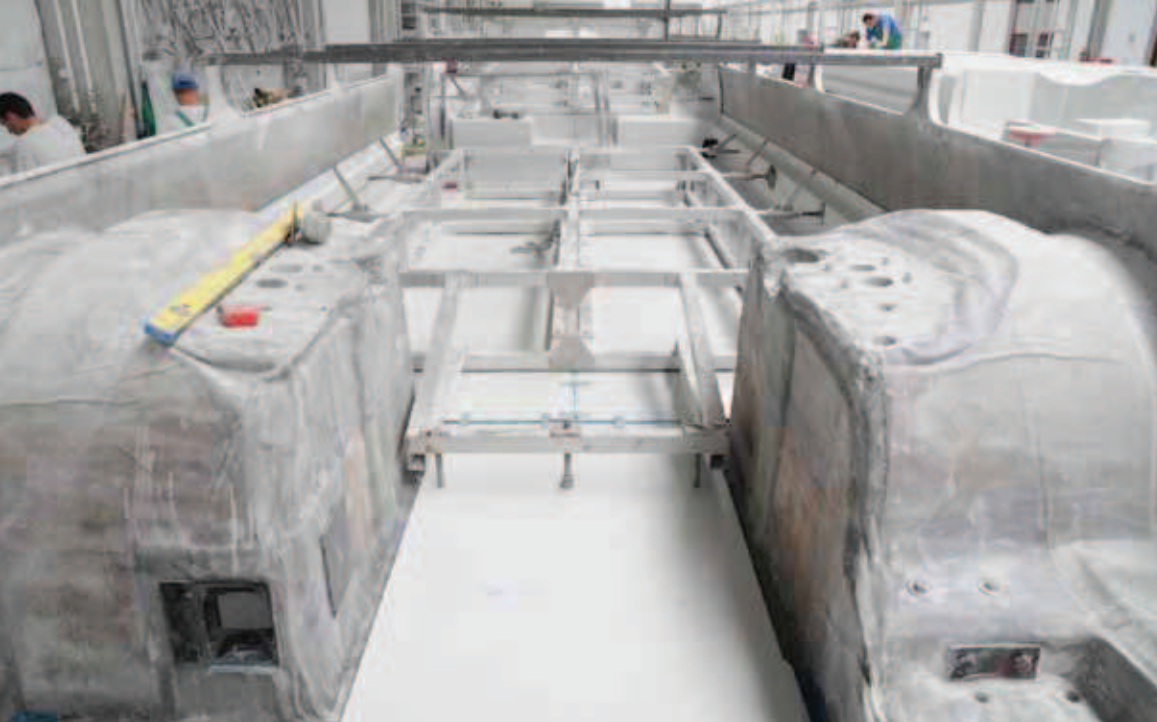
71. ábra, Padlólemez beragasztása
