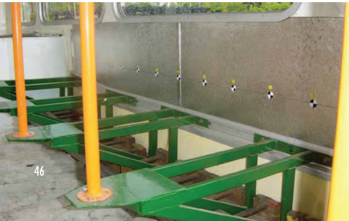
34. ábra, NABI 60 BRT ütközési teszt, becsapódási felület az utastér felőli oldalon
