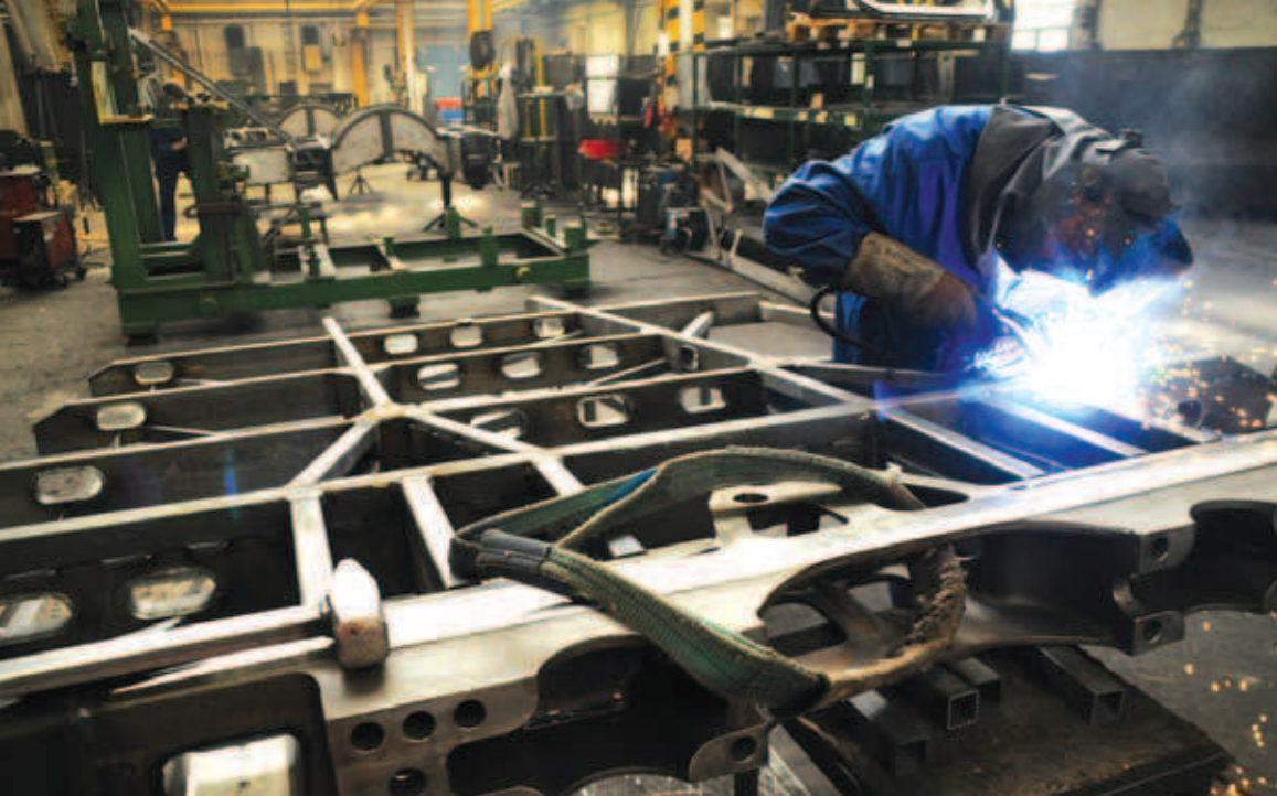
22. ábra, NABI 60 BRT alvázának hegesztése
