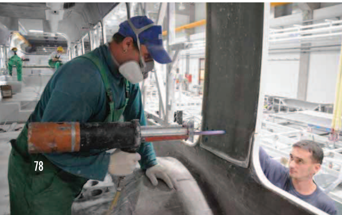
78. ábra, Alakos kötészű elemek közti rész kitöltése ragasztóval furatokon keresztül
