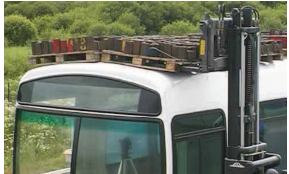
96.-97.-98-99. ábra, NABI 45 C LFW CompoBus tetőterhelési teszt (Kaposvár)
