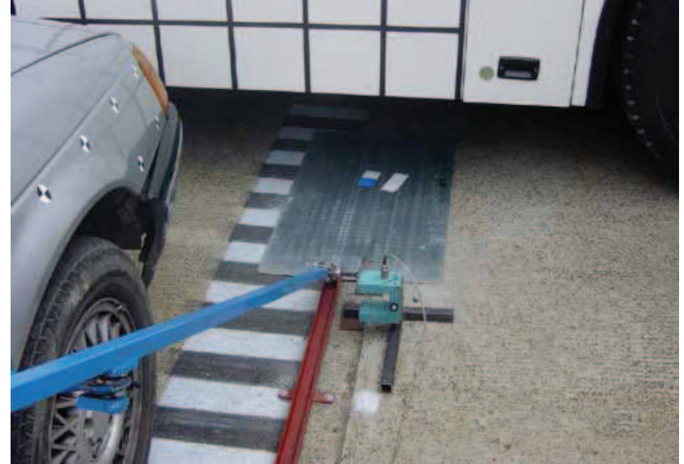
37. ábra, Találkozási pont, sebességellenőrző stroboszkóp felfestés
