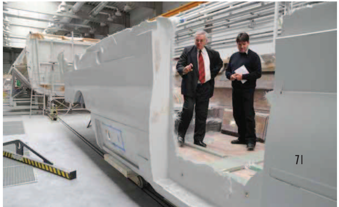
67. ábra, Szerszámból kiemelt héjszerkezet
