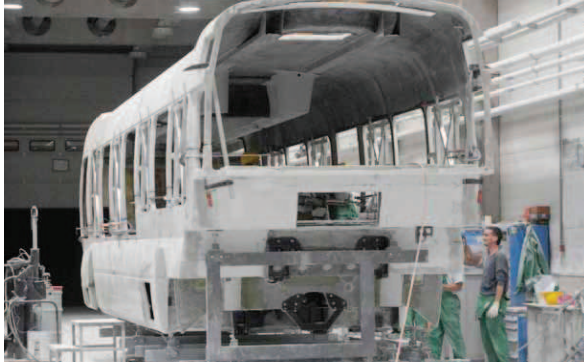
79 ábra, Egyben az összeillesztett és ragasztott két fél elem
