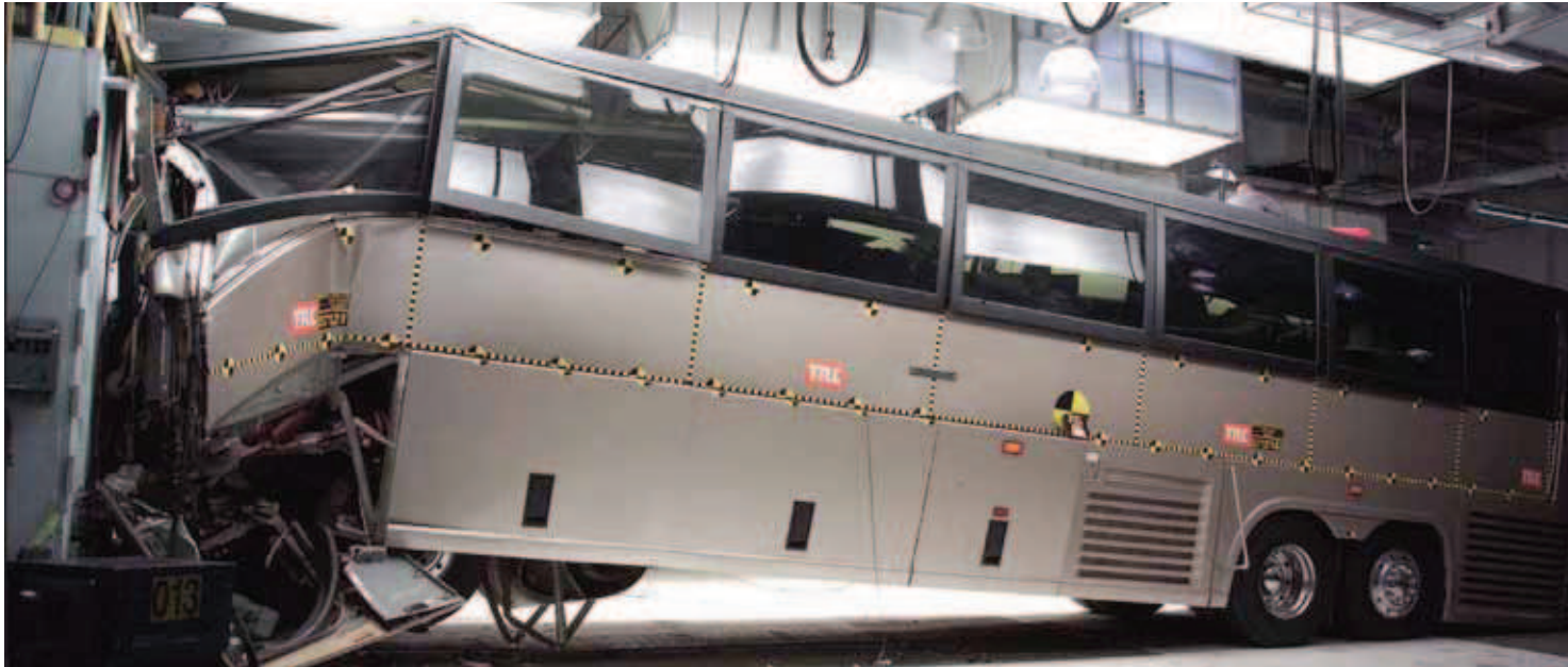
86. ábra, Transportation Research Center Inc törésteszt végső állapot
