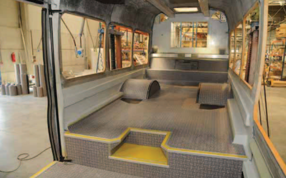
81. ábra, Felragasztott Taraflex padló burkolat
