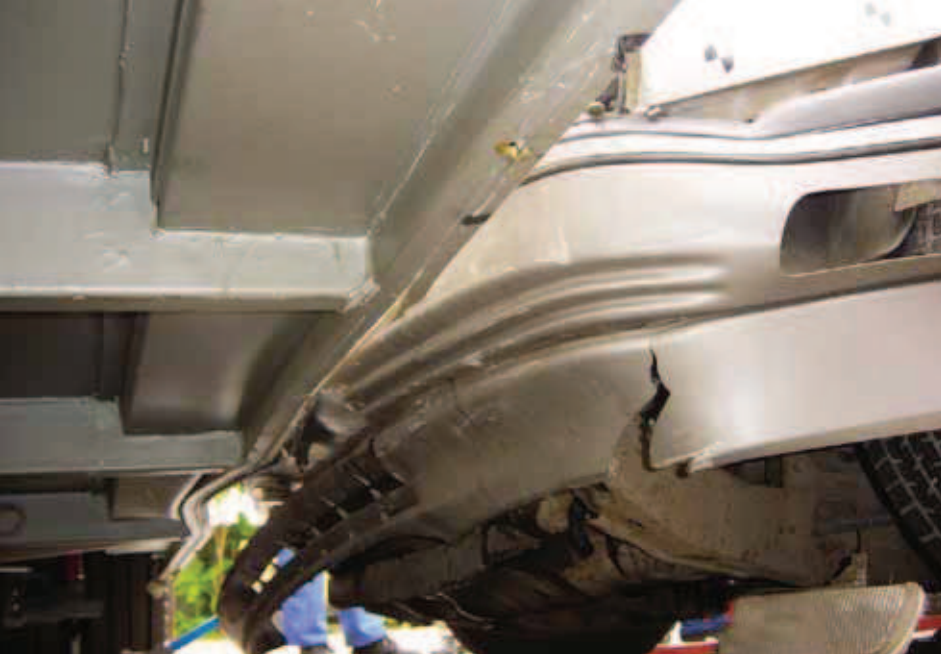
36. ábra, Deformáció mértéke a fenékváz felől
