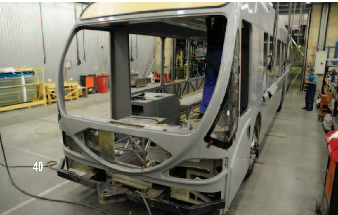
27ábra, NABI 60 BRT szélvédőjének beragasztása
