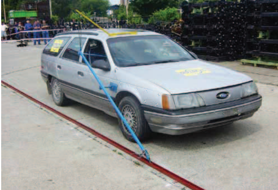
35. ábra, Távirányított vezető nélküli tesztautó
