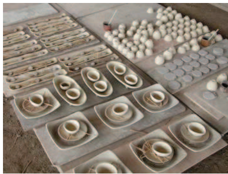
36 Égetésre előkészített nyers edények választómasszával, szalmával
