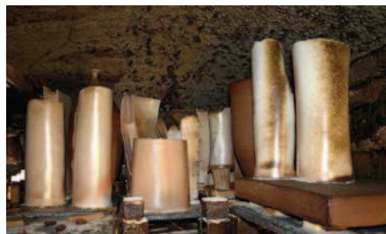
67 Hengerek a huzatiránynak megfelelő hamulerakódással
