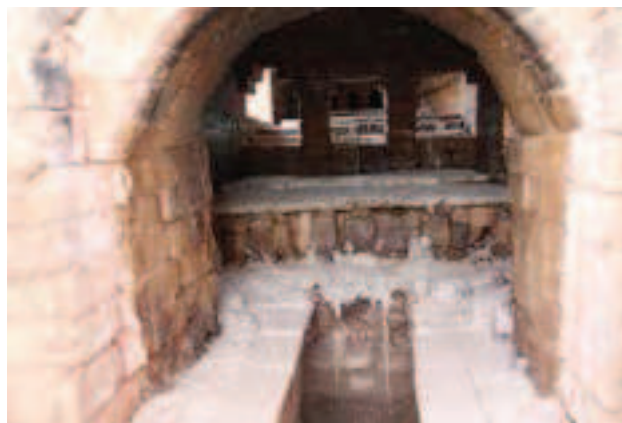
50 Frederick Olsen kemencéjének belső tere bepakolásra és égetésre előkészítve. Középen a lángcsatornák, a háttérben pedig a 2. kamra látható
