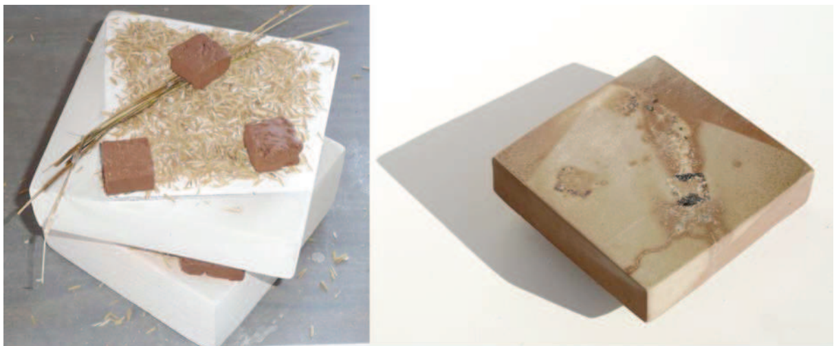
Sóoldatba áztatott szalma, rizspelyva és választómassza a kerámián égetés előtt és után
