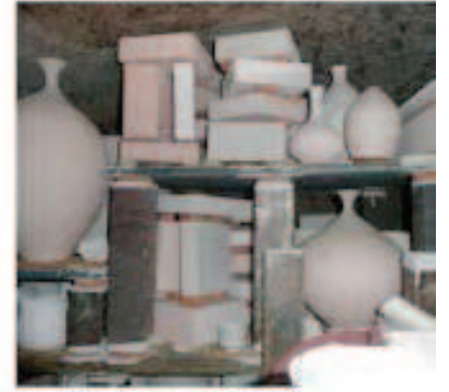
51 Néma Júlia: Rakathoz előkészített hasábok. Választómasszával összeállított rakat, illetve rakatok a kemencetérben
