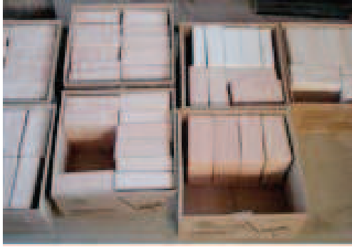
51 Néma Júlia: Rakathoz előkészített hasábok. Választómasszával összeállított rakat, illetve rakatok a kemencetérben
