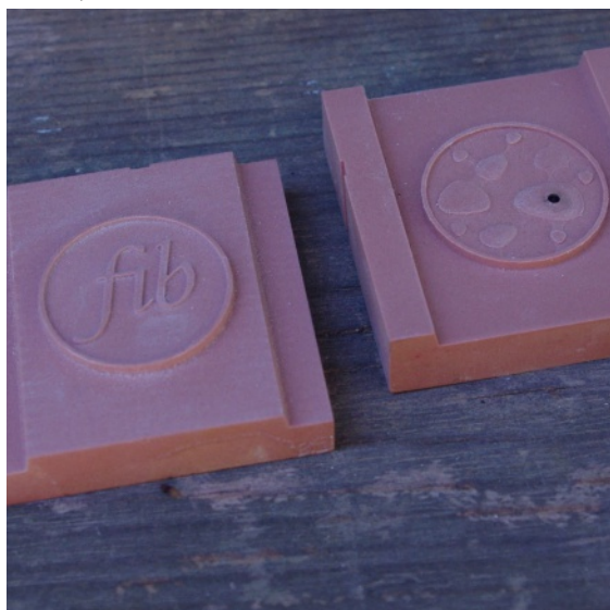
46. kép / Öntött beton érme mart öntőformája
