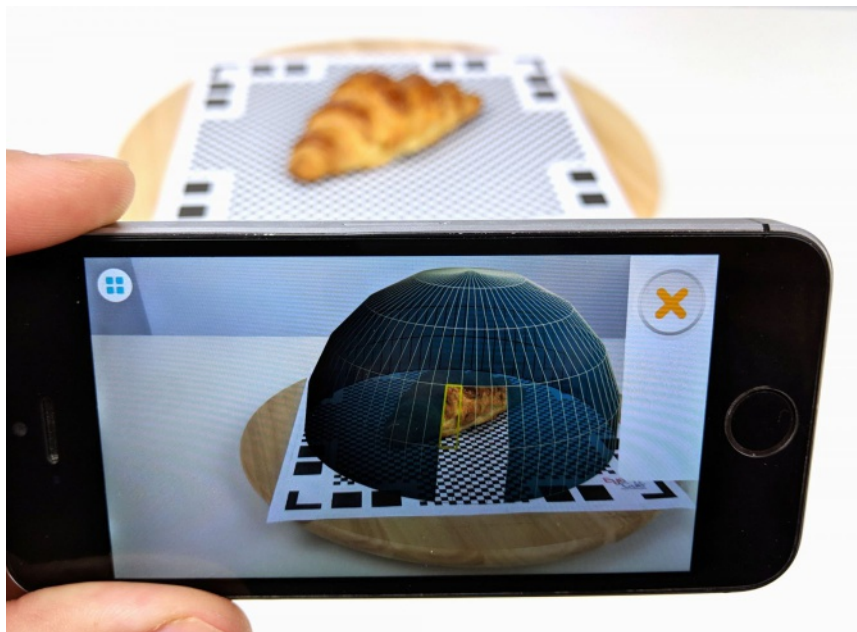
20. kép / Fotogrammetria telefonos applikációval
