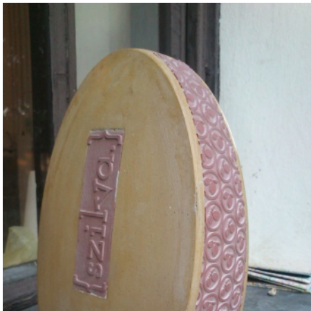
65. kép / mart felületi kialakítás
