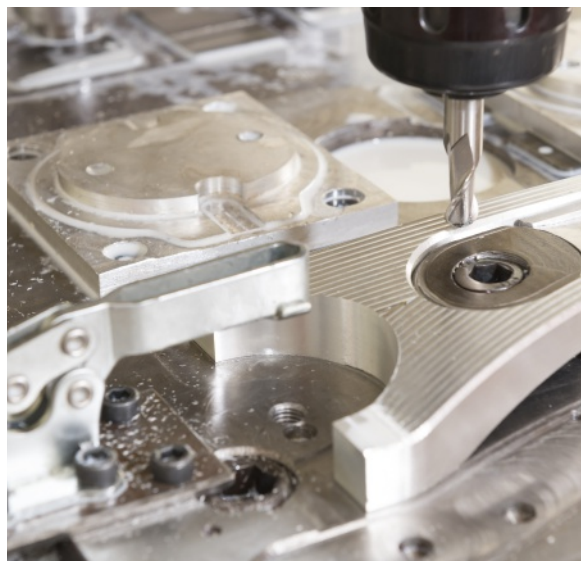
30. kép / Alumínium CNC marása
