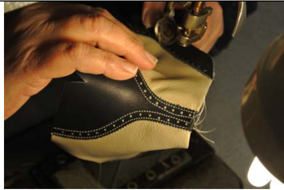
Kép 55: 26-os fiúcipő felsőrészének tűzése
