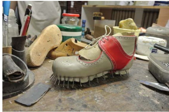
Kép 56: 26-os lánycipő fárahúzva
