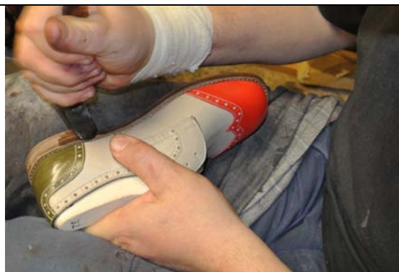
Kép 62: 32-es fiúcipő talpszélének vasalása
