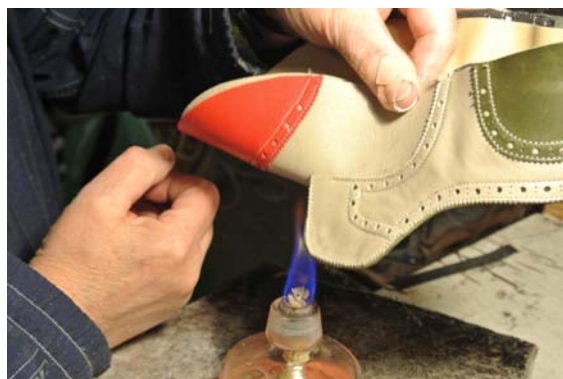
Kép 60: A kész 32-es fiúcipő felsőrésznél lángolása
