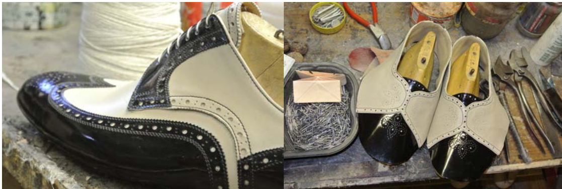
Kép 64: 42és feles férficipő fárafoglalva és 37és feles nőcipő felsőrésze fárafoglalás előtt
