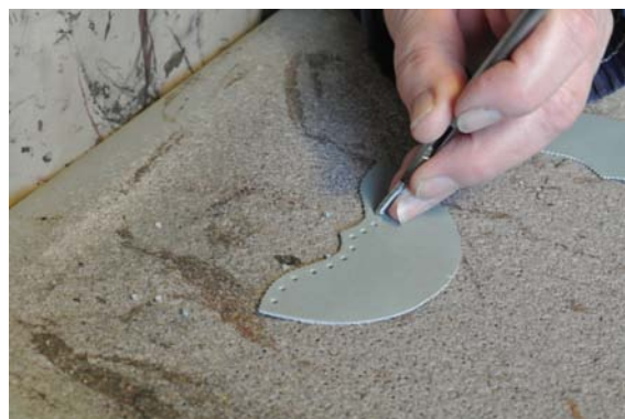
Kép 50: Szárnyaskapli lyukasztása
