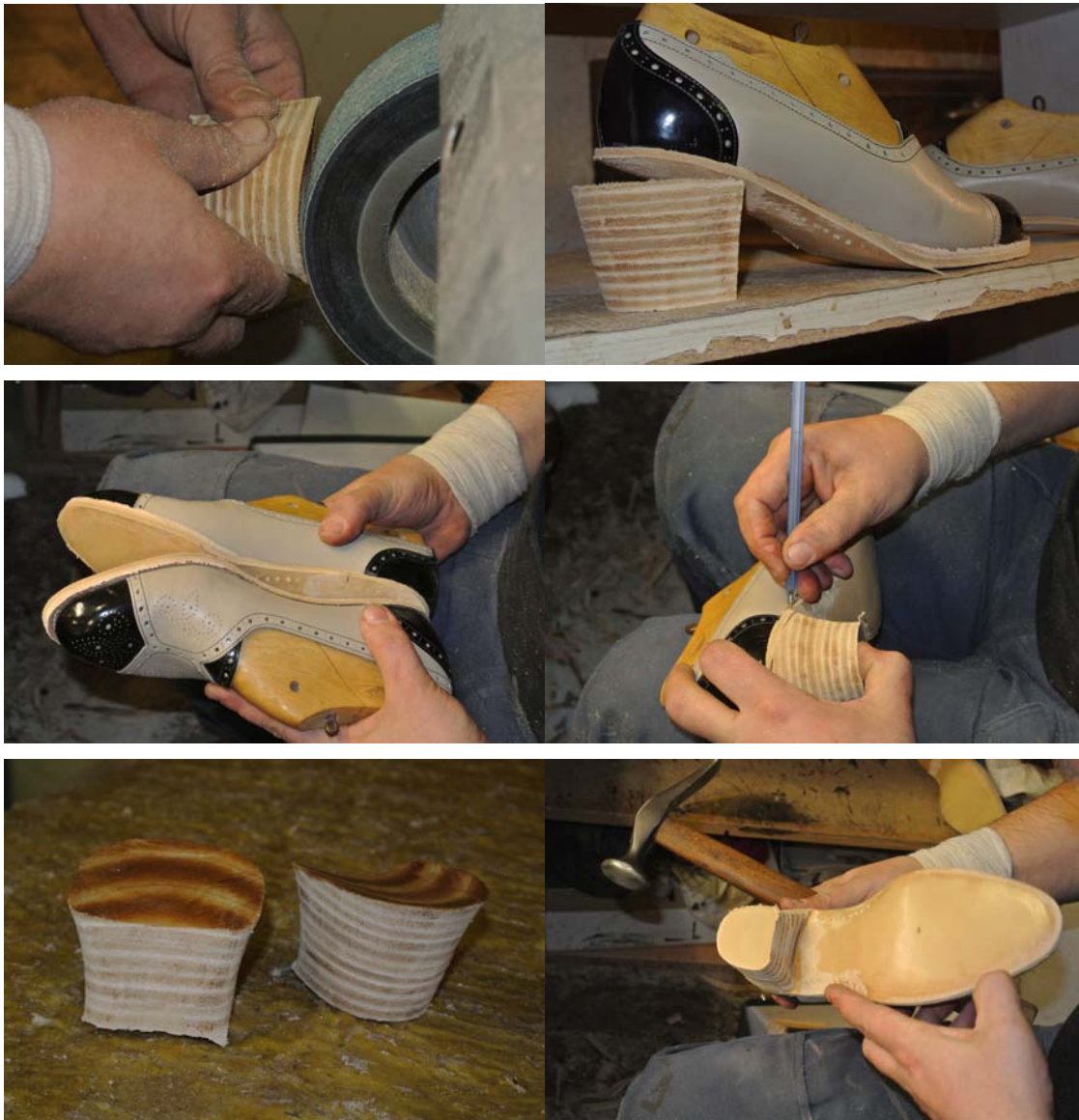
Kép 66: 37és feles magassarkú nőicipő sarkalása
