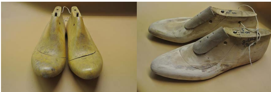
Kép 43: 37és feles magassarkú női kaptafa és 42és feles átcsiszolt férfi kaptafa
