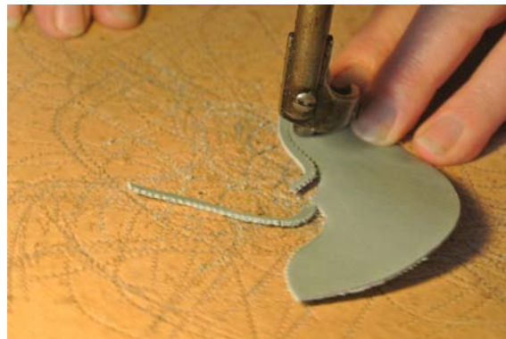
Kép 49: Szárnyaskapli cakkozása
