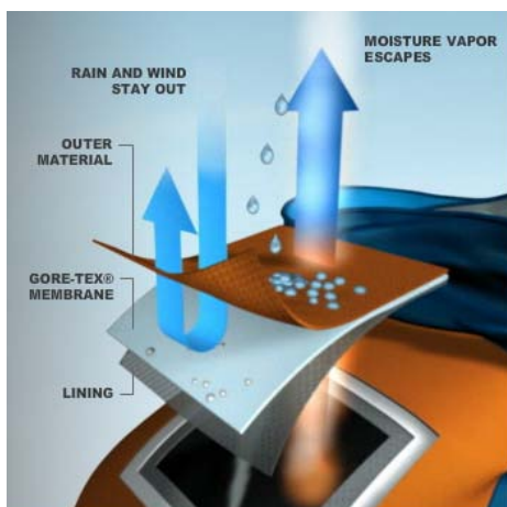
Kép 7: A Goretex anyag szerkezete
