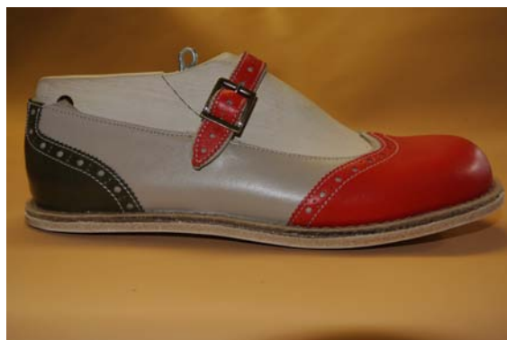
Kép 61: 32-es lánycipő kész talppal a saroképítés előtt
