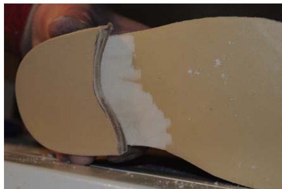
Kép 57: 26-os fiúcipő ragasztott, préselt íves saroka
