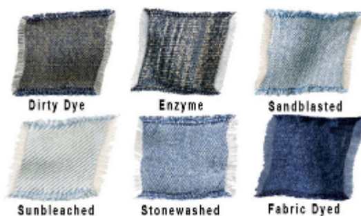
77. „Koszosítás”, enzim-mosás, homokfúvás, (fakítás) hipózás,
