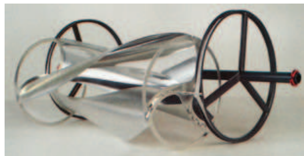
A forgórész tengelyét gumiszalagok feszítik a homorú felületű gyűrűk éleire. A gumi tapadása nagyobb, ezért a rotor azon legördülve, az éleken elcsúszva körbehalad.
