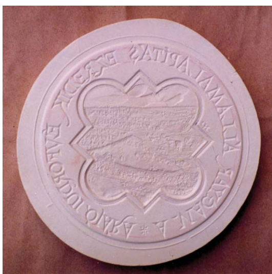
15. MEGYEI ÉREM AZ ÁLLAMALAPÍTÁS ÉVFORDULÓJÁRA, 2002 vésett gipsznegatív a verető elkészítéséhez, átmérő: 155 mm
